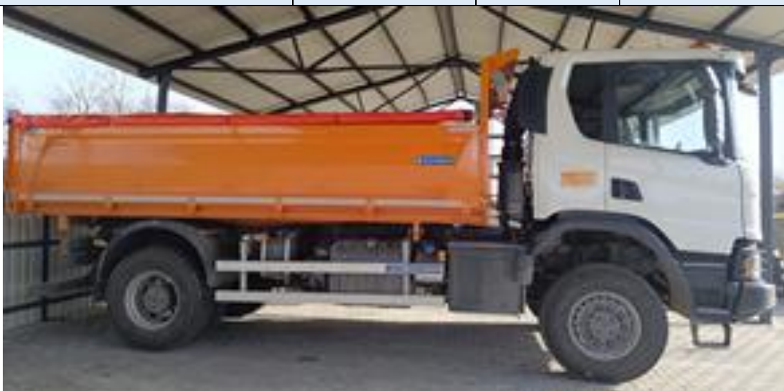
Samochód ciężarowy 4x4 samowyladowczego dla potrzeb działań przeciwpowodziowych dla GZUP w Baranowie Sandomierskim.
